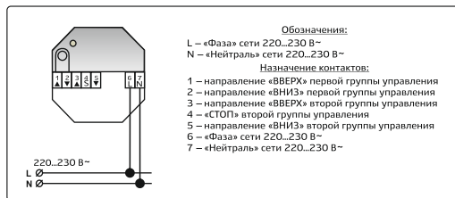
Рисунок 1 – Подключение Nero II 8410 UP к сети и назначение контактов
