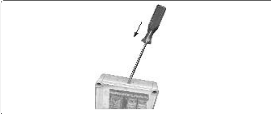
Рисунок 1. Выбивание отверстия для кабельного ввода
